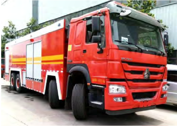
Fourgon Pompe Tonne Grande Capacité « FPT GC » (16 000 litres d'eau et 4000 litres d'émulseur)
